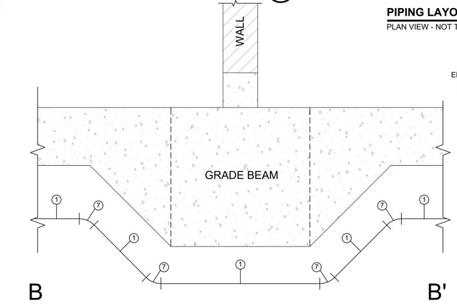
**PIPING LAYOUT UNDER INTERIOR GRADE BEAMS/DRAIN LINES**
