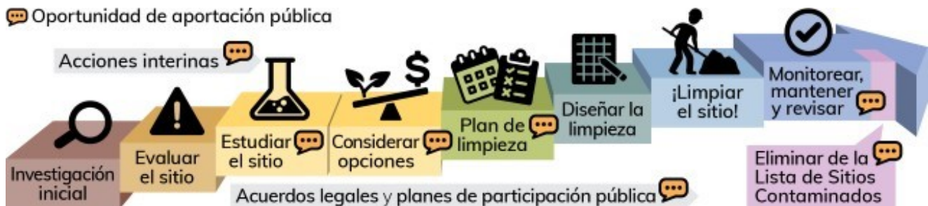
Imagen 2: Proceso de limpieza formal de Washington.
