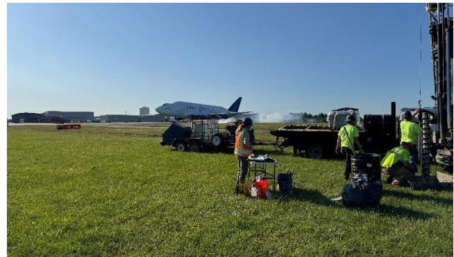
Lấy mẫu đất tại khu vực vào năm 2024
