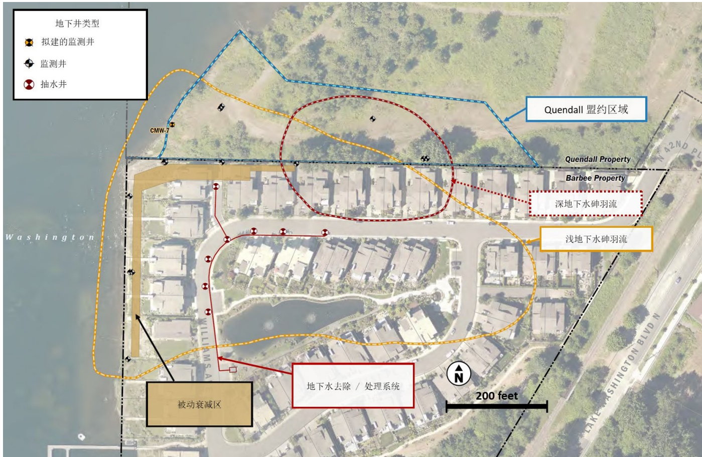
图 3 显示了该场地生态规划选定的清理行动细节。所述清理行动已实施。该图的更详细版本可参见第 41 页的清理行动计草案 (图 9：清理行动方案 1 概念布局)。
