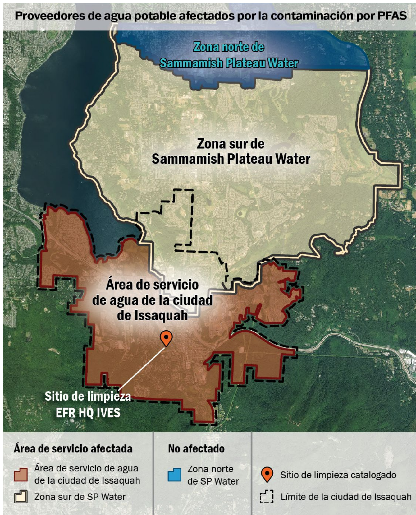
Imagen 2: El área de servicio de agua de la ciudad de Issaquah y la zona sur de Sammamish Plateau Water tienen pozos de suministro de agua potable afectados por la contaminación por PFAS. Ambos proveedores de agua cumplen con los niveles seguros de agua potable.
