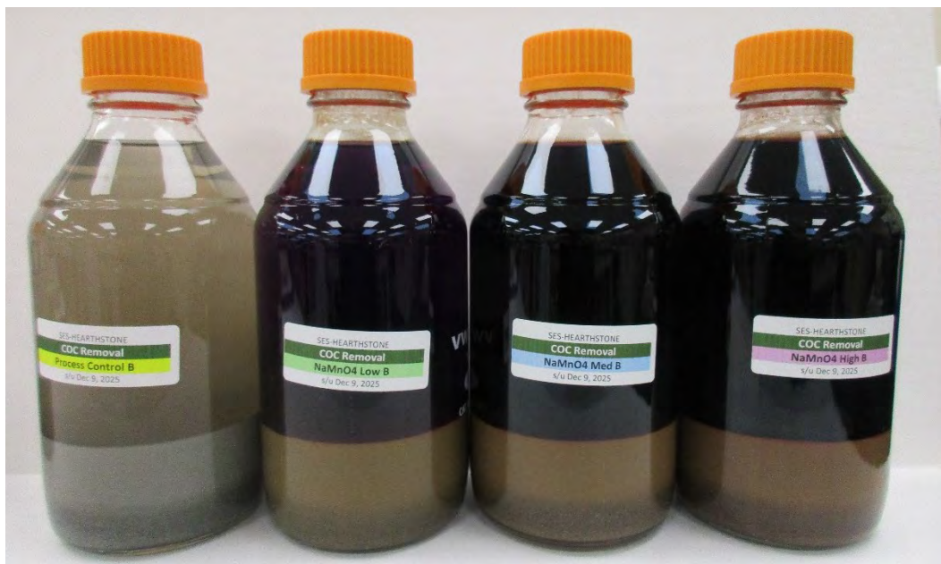
Figure 2. COC Removal Reactors – Day 28. From left: Control, NaMnO 4 -Low Dose, NaMnO 4 -Med Dose, NaMnO 4 -High Dose.
