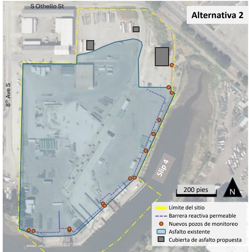
Ubicaciones aproximadas de las acciones de limpieza descritas en la alternativa 2.
