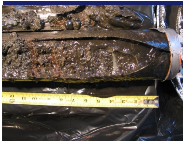
Photo 31 NS19 core upper interval. Note NAPL.
