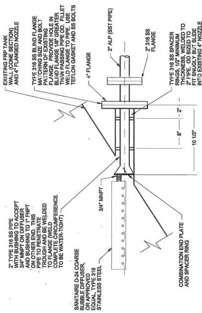
**DIGESTER TANK AERATOR DETAIL**
