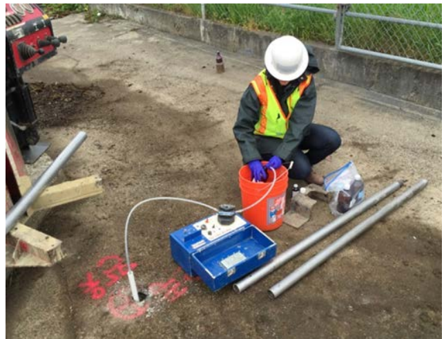
Geóloga Jill Betts, LG, muestreando agua subterránea de un barreno temporal con una bomba peristáltica. Foto por David Coles.
