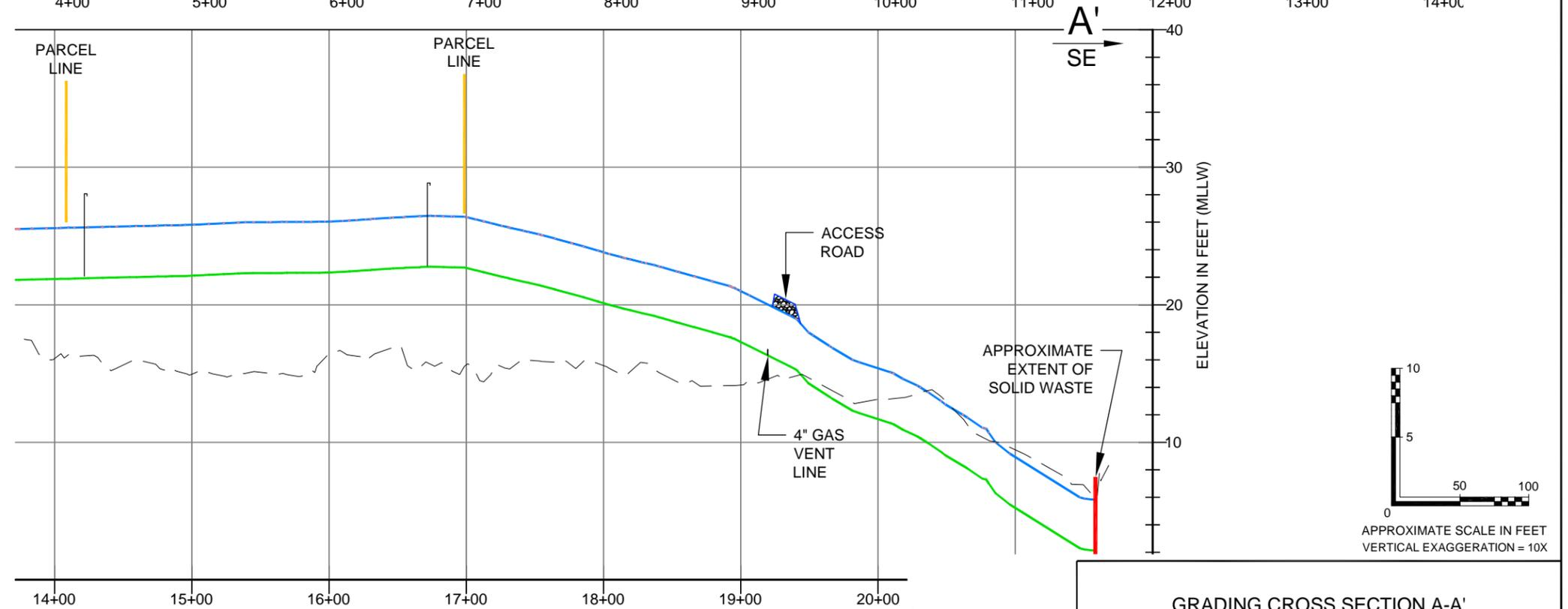
GRADING CROSS SECTION A-A'
