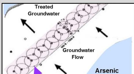
A lo largo del borde de la ribera de B2 (no se muestra en mapa), el plan es instalar una barrera reactiva permeable. Esta barrera se crea mediante la inyección de químicos en la tierra. Los químicos forman una “pared de tratamiento” que reacciona con el arsénico a medida que pasa a través del área de tratamiento. El arsénico es luego quitado de las aguas subterráneas y dentro el suelo donde se mantiene en sitio.
