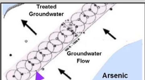
Dọc theo cạnh bờ sông của khu vực B2 (không có trên bản vẽ), kế hoạch là cài đặt một rào cản phản ứng thẩm ngầm. Rào cản này được tạo ra bằng cách tiêm hóa chất vào mặt đất. Các chất hóa học tạo thành một "bức tường xử lý" để phản ứng với thạch tín (arsenic) khi xuyên qua khu vực xử lý. Chất arsenic sau đó được hút ra khỏi nước ngầm và trong đất nơi arsenic bị cô lập.
