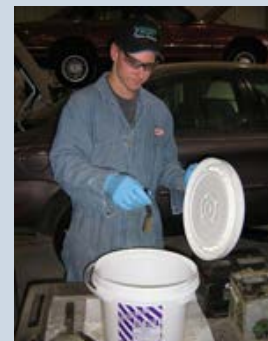
Figure 1. Trabajador automotriz coloca un interruptor de mercurio en la cubeta de recolección
