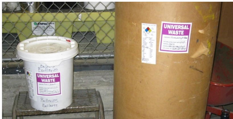
Gráfico 6: contenedores de residuos universales para pilas y tubos fluorescentes, cerrados y etiquetados adecuadamente
