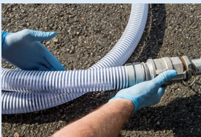
Un hidrólogo muestra una manguera que lleva comida para bacterias al agua subterránea contaminada.
