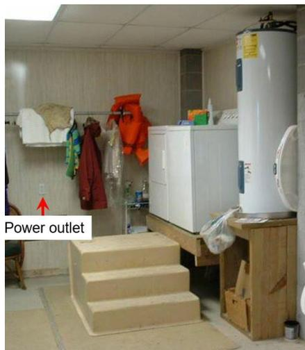
La lavadora, la secadora y el calentador de agua fueron elevados en este garaje impermeabilizado.
