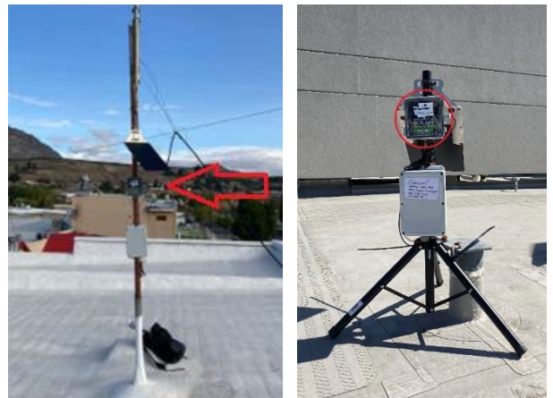
Un SensWA en el poste de una antena en un techo (izquierda) y en un trípode de Ecología (derecha).
