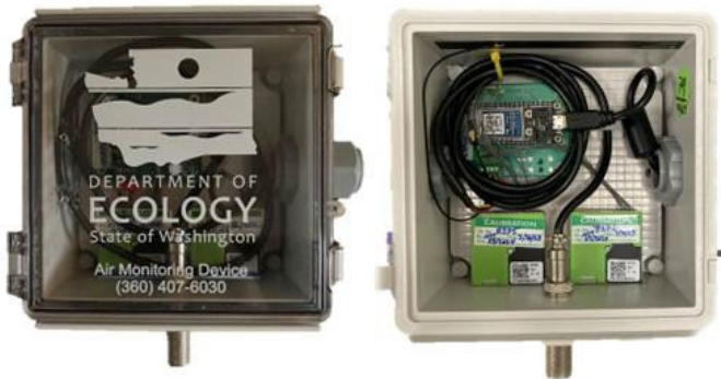
Instrumento sensor SensWA (6”x6”x4” y aproximadamente 3 lbs)
