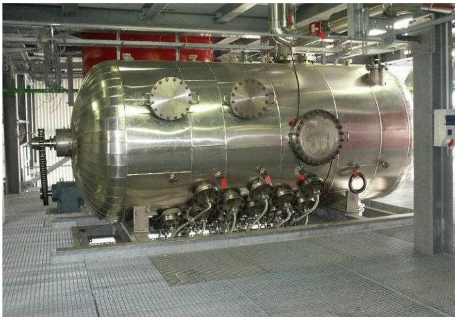
**Figure 73.** Paddle pyrolysis reactor used by Choren ([http://www.fnr-server.de/cms35/fileadmin/allgemein/pdf/veranstaltungen/BtL\\_Berlin\\_2008/4\\_Blades.pdf](http://www.fnr-server.de/cms35/fileadmin/allgemein/pdf/veranstaltungen/BtL_Berlin_2008/4_Blades.pdf), date accessed: Nov. 13, 2010).
